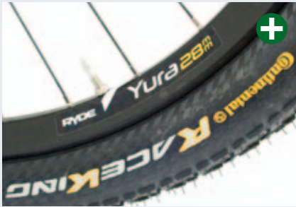
28 mm breite Ryde Yura-Felge am Velo- Traum: ermöglicht niedrigere Luftdrücke, mehr Komfort, bessere Traktion.
