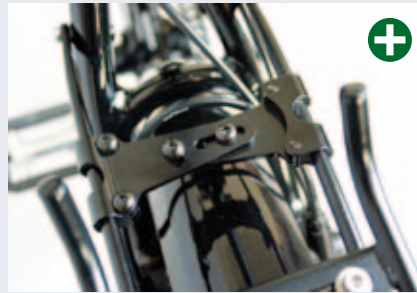
Zusätzliche Schutzblech-Strebe und Gepäckträger-Verstärkung namens „Brace“ am Idworx: Gepäck wie angenagelt.
