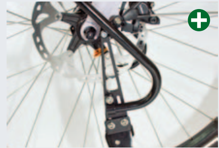
Lowrider-Ständer am Poison: einfaches Zubehör, dass das Beladen extrem erleichtert. Idworx löst das mit Lenkansschlag.
