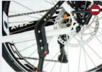
Seitenständer mit Rahmenadapter am kurzen Schauff-Hinterbau: Hier können die Fersen anecken.
