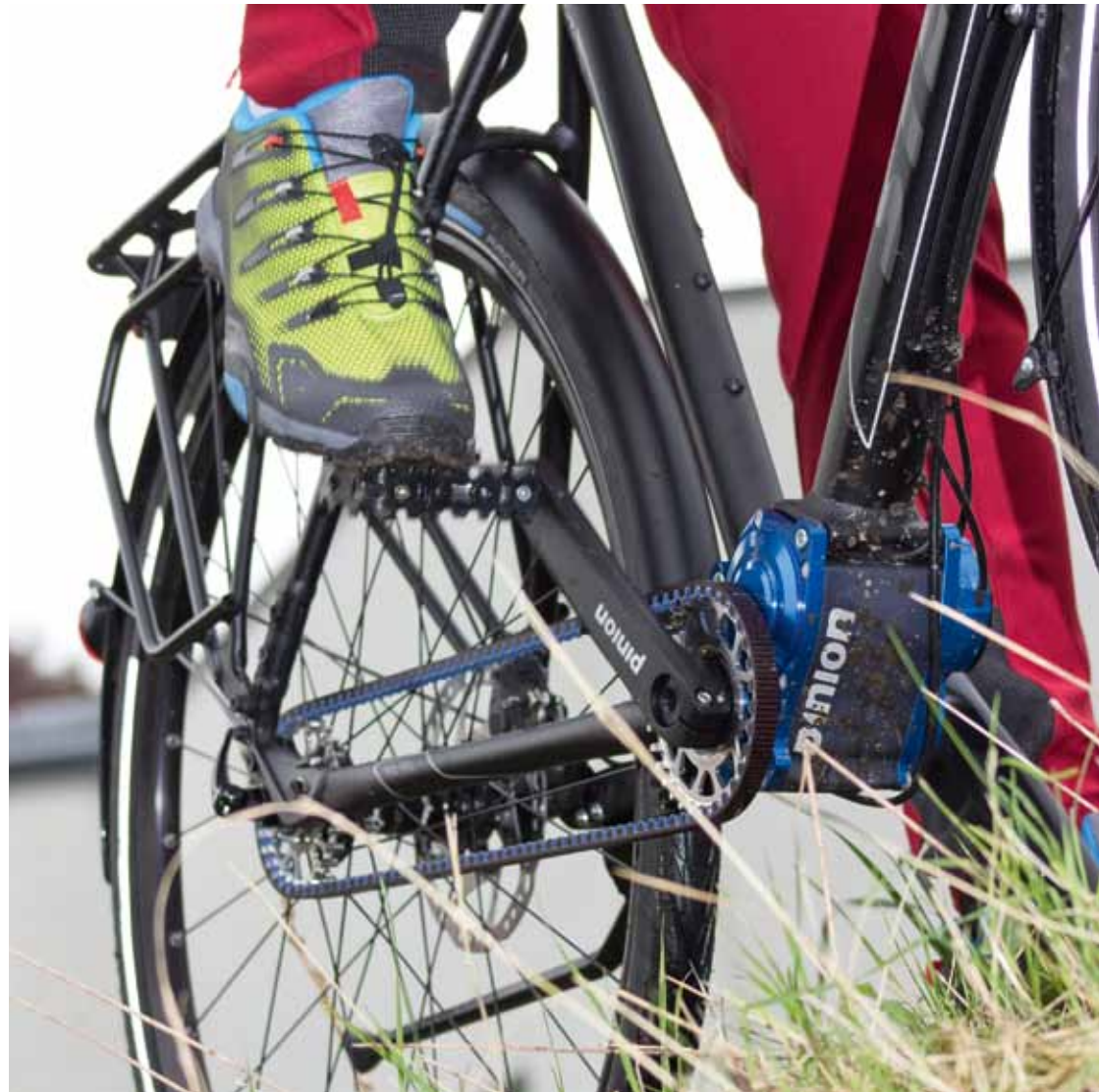
Das Pinion-Getriebe und der Gates-Riemenantrieb harmonieren sehr gut.
