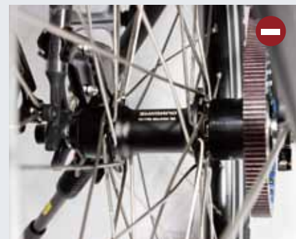
Weniger konsequent: Eine normale XT-Nabe verschenkt das Potenzial des Getriebes, wird aber nur bei Böttcher eingebaut.
