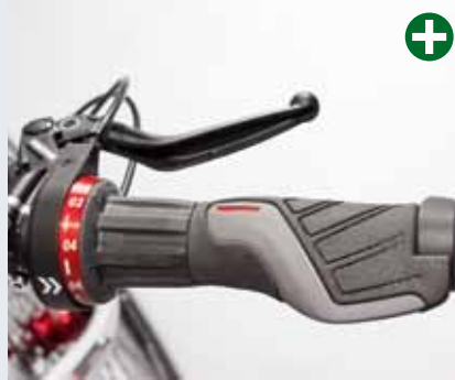
Mit guter Ergonomie: Bremsgriffe der Magura MT4-Discbremse und die geschraubten Flügelgriffe am Staiger.
