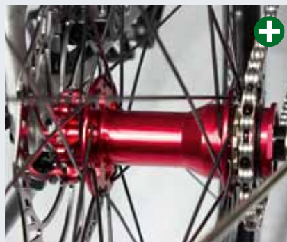
Konsequent: Eine Singlespeed-Nabe ermöglicht ein symmetrisch eingespeichtes, seitensteiferes Hinterrad – hier am Staiger.
