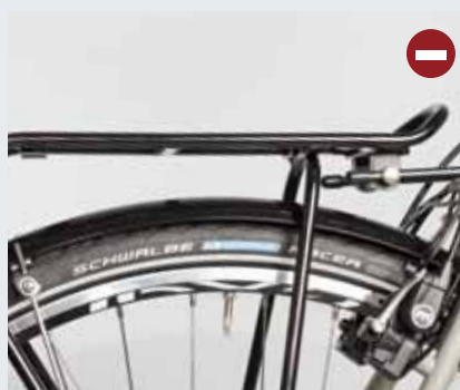
Nicht optimal: Die hohe Ladefläche am Patria bringt den Schwerpunkt mit Gepäck nach oben – der Baukasten bietet Alternativen.
