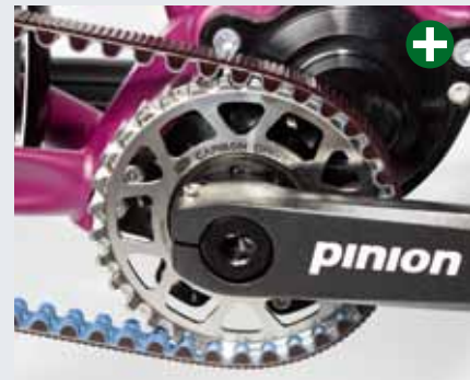
Schmierfrei: Die Pinion-Bikes von Stevens, Böttcher und Poison (im Bild) besitzen einen Gates-Riemenantrieb.
