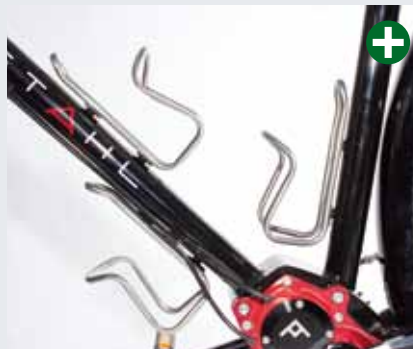
Alleinstellung: Drei Ösenpaare für die Montage der entsprechenden Zahl Flaschenhalter bietet nur Rennstahl – mit Haltern aus Titan.
