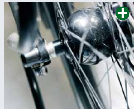
Energie geladen: Steckerloser Kontakt zum Top-Dynamo und ein Kabelbaum für das Licht und den USB-Lader zeichnen das Idworx aus.
