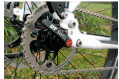
Alles für die Wartungsarmut: großes 35-Zähne-Ritzel aus Messerstahl und DT-Steckachse.
